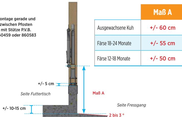
Montage gerade und an Vorderseite mit Stütze P.V.B. 860459 oder 860583
