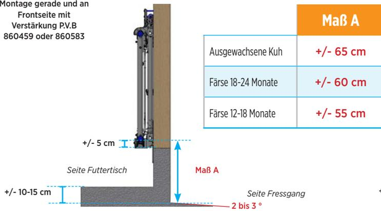
Montage gerade zwischen Pfosten mit Mittelstütze zum Einbetonieren
