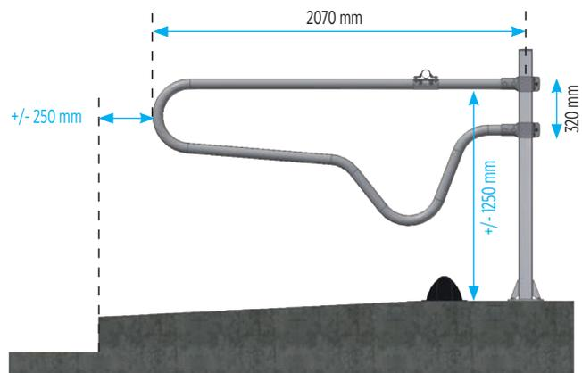
In Höhe und Breite einstellbar am Trägerrohr
