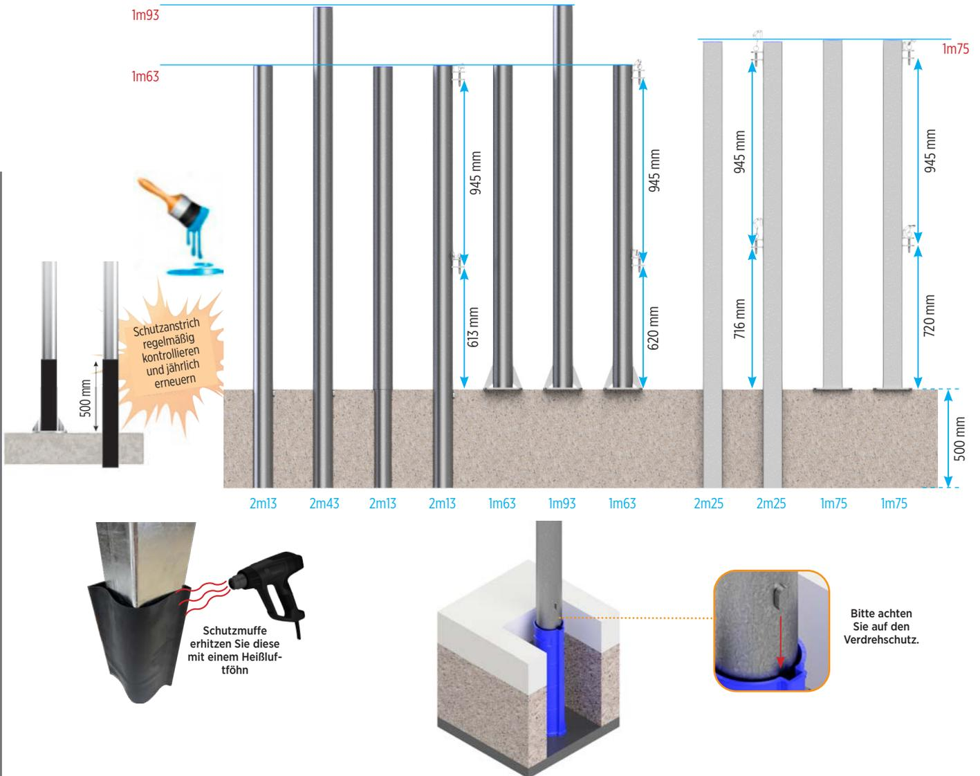
Die Heiverzinkung schtzt dauerhaft vor Rost. Trotzdem kann ein lngerer Kontakt mit aggressiven Medien wie Silage, Mist und Jauche, besonderen Bodenbehandlungen (Kalk) Rost bewirken. Deshalb empfehlen wir, dass Sie die Gegenstnde, die mit solchen Medien in Kontakt kommen, entsprechend lackieren und die Beschichtung regelmig erneuern. **Siehe Seite 41**
