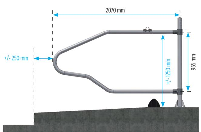
In Höhe und Breite einstellbar am Trägerrohr
