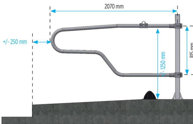
In Höhe und Breite einstellbar am Trägerrohr
