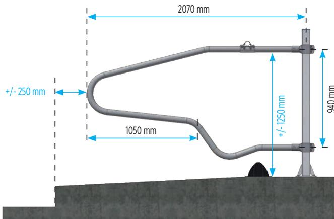
In Höhe und Breite einstellbar am Trägerrohr
