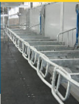
**■** Zeer robuuste snelwissel melkstal. Pneumatische bediening standaard of optioneel hydraulisch bediend, omhoog draaiend hekwerk, met instelbare standlengte. Zorgt voor de hoogste melkcapaciteit. Door het portaalframe wordt de vloer belast en niet de wanden. Leverbaar met optie voerbakken.
