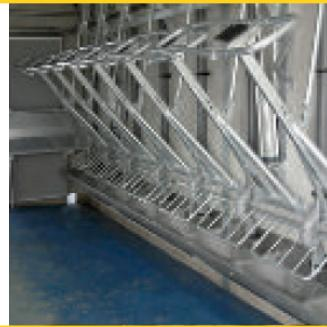
Een elektrisch bediend scheppend geiten of schapen drijfhek met ketting- aandrijving. Het onderhek beweegt omhoog over de volgende groep. Onderhek kan met of open gaas of met een dichte aluminium plaat uitgerust worden. Zoemer bij voorruit rijbeweging.
