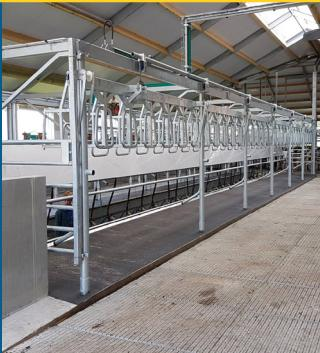
**■** Rapid Exit melkstal met electro/hydraulische bediening, fronthek verticaal omhoogbewegend zonder uitzwaai, geen palen tussen de koeien in, geheel vrije uitstapruimte. Tot 2x60 standen mogelijk, als optie met voerbakken leverbaar.
