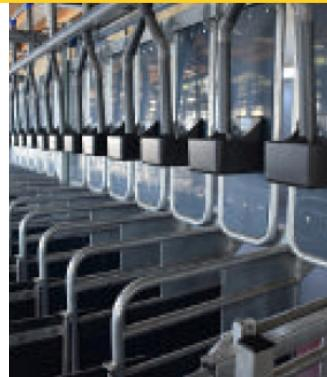
Geiten- of schapenmelk-stal met degelijke zwevende pootloze constructie voorzien van grijze kunststof panelen. Onderhoudsarme veerloze RVS scharnierpennen en maximaal overzicht. Door de zwevende boxen kan eenvoudig onder de boxen gereinigd worden, en geeft een maximaal overzicht.
