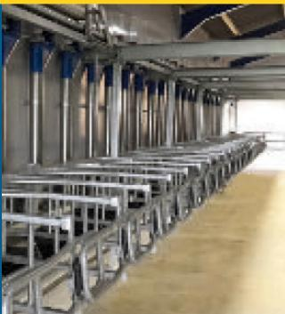
**■** Snelwissel met pneumatische of hydraulische bediening, verticaal omhooglopend hekwerk geeft onbelemmerde royale wegloop. Maakt de hoogste melkcapaciteit in de kleinste ruimtes mogelijk, met een wegloop aan de voorzijde van de stal. Tevens met de optie voerbakken mogelijk.
